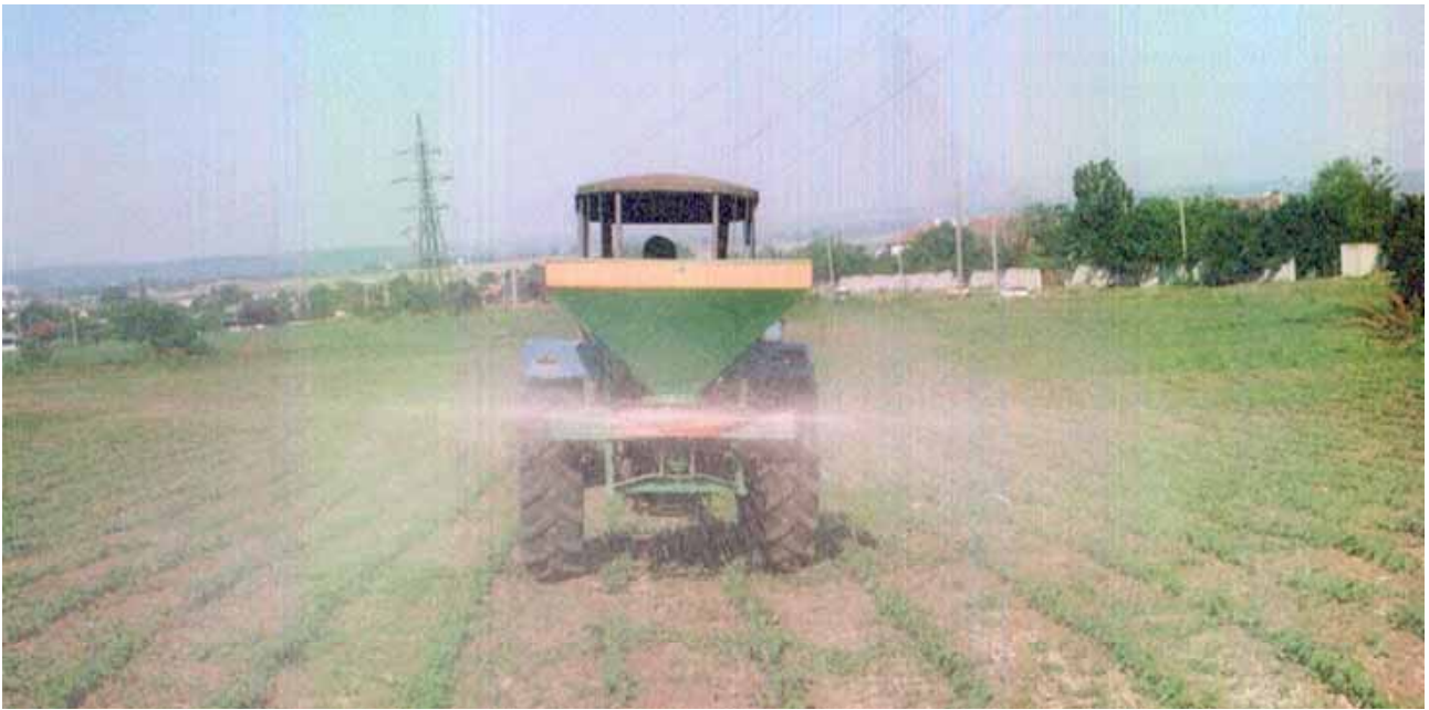
Fig. 3 Agregatul format din tractorul U445 și mașina MIC-0,4M echipată cu discul \Phi 600 mm, în lucru
