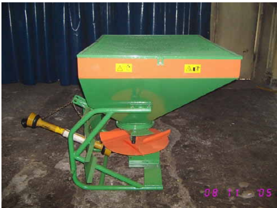
Fig. 1 Mașina de împrăștiat îngrășămintă chimice solide MIC-0,4M – vedere laterală
