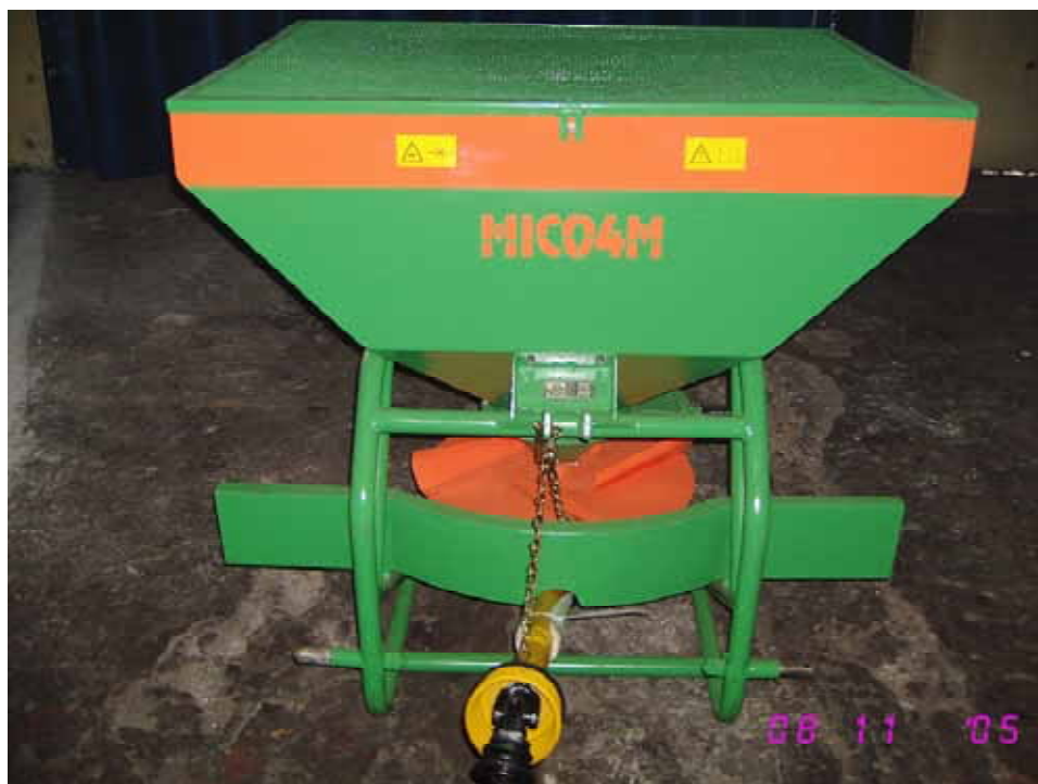
Fig. 2 Mașina de împrăștiat îngrășăminte chimice solide MIC-0,4M – vedere din față
